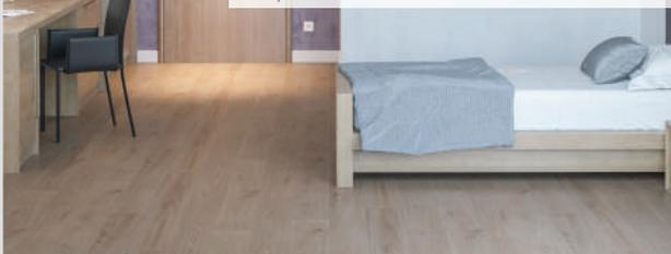
Chez Forbo, l'objectif bien-être et confort est d'ailleurs une priorité. « Modul'up assure une efficacité acoustique de 19 dB, soit une réduction des bruits de chocs de 19 dB par rapport à une dalle béton brute », souligne, à cet effet, Joël Nunes. Une performance inédite pour un produit à effet plombant, « qui dépasse même les exigences de la réglementation sur les bâtiments neufs ».
